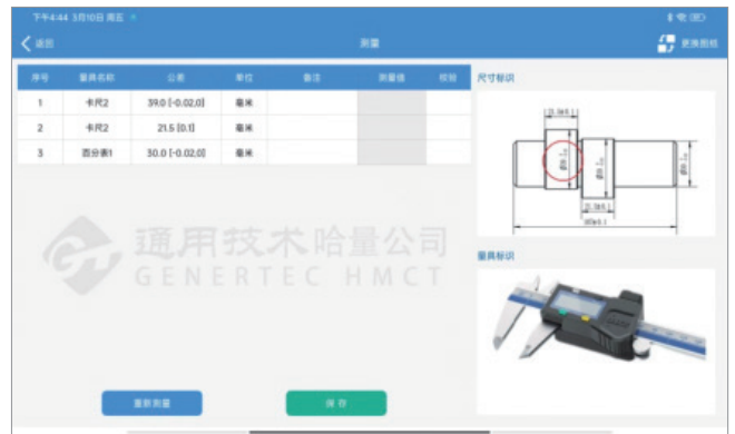
移动端测量软件主界面
