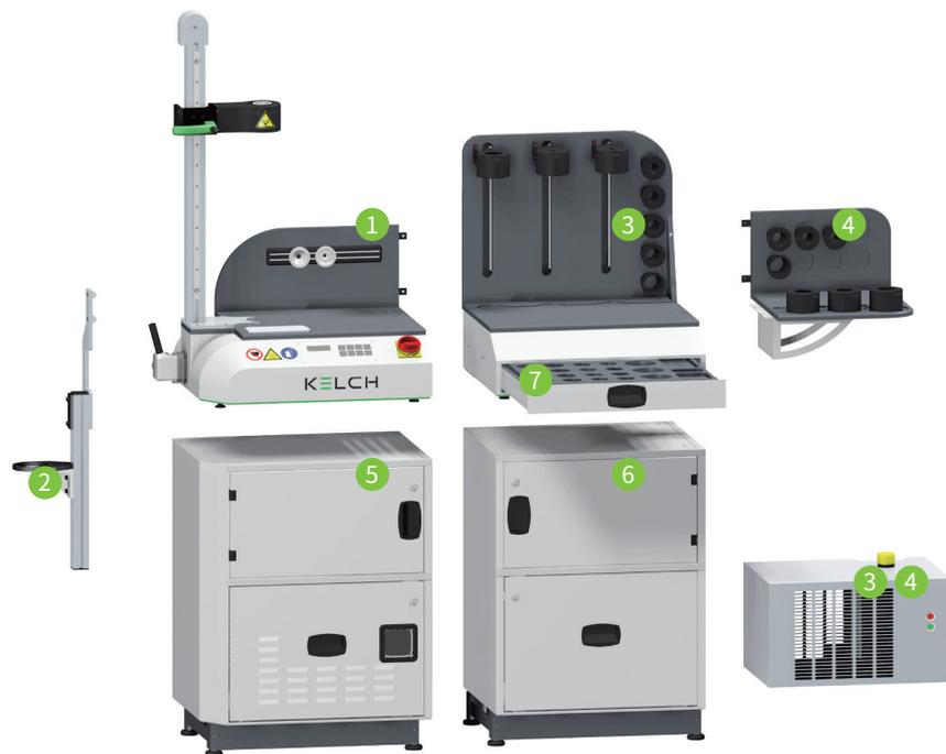
灵活配置热套装置。根据自己的需求添加适用的模块组件，将现有低成本入门热套机升级。
