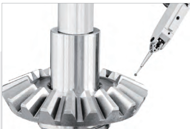
直齿锥齿轮测量 Straight bevel gear
