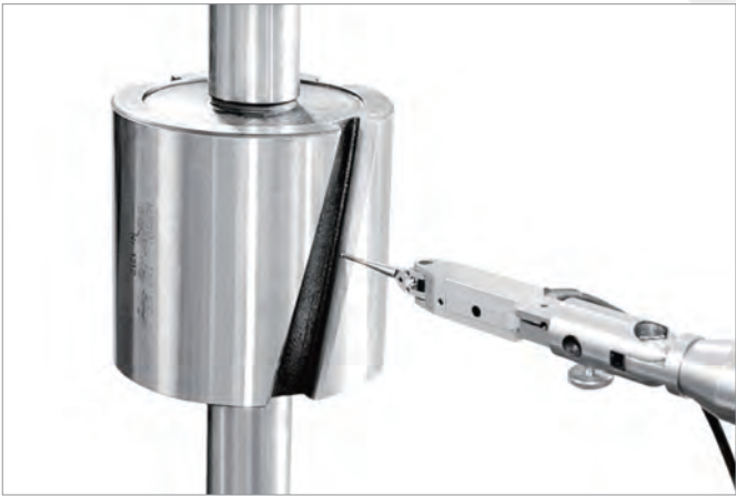
螺旋线样板测量 Lead master
