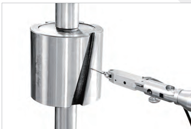
螺旋线样板测量 Lead master
