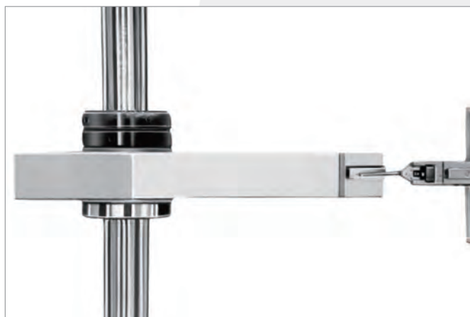
渐开线样板测量 Involute master
